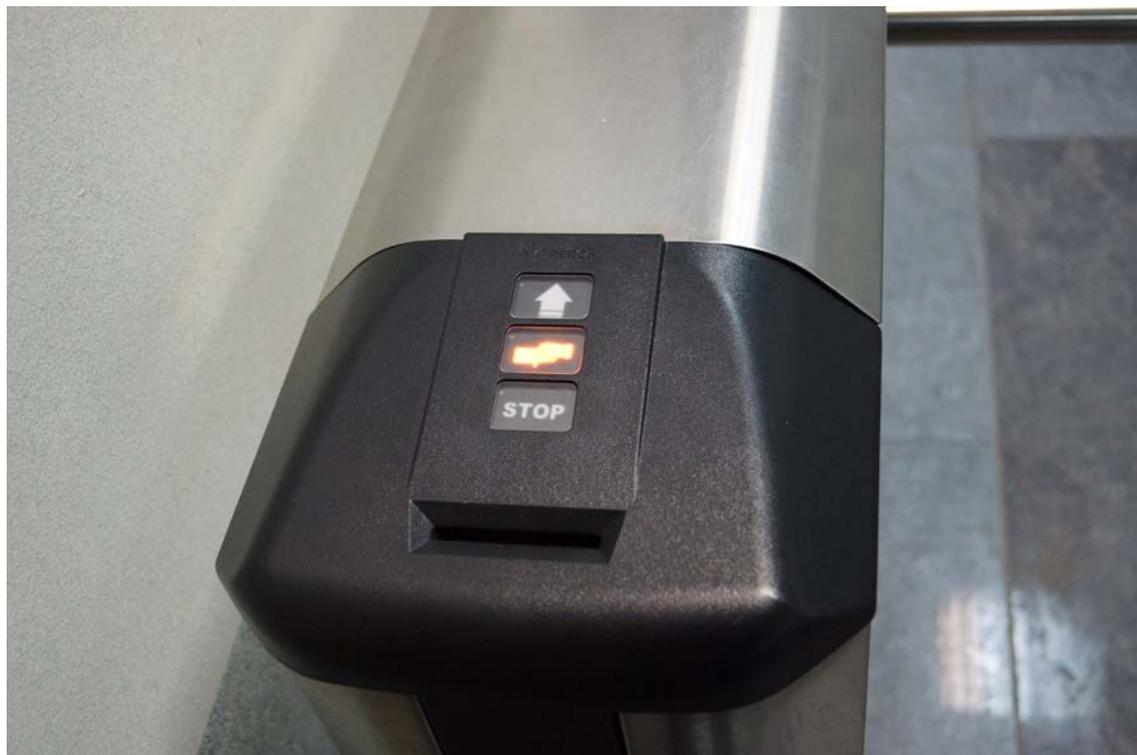
Приложение 4 Считыватель пластиковых пропусков на автопроходной
